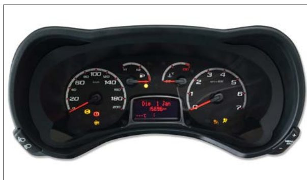
Un ou plusieurs voyants de contrôle restent allumés faiblement après coupure du contact
