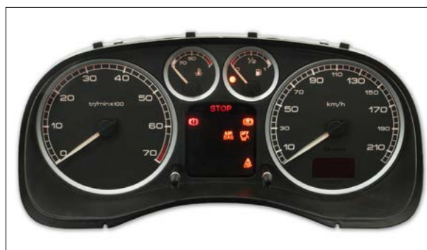
Affichage analogique défaillant
