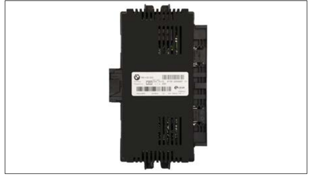
Dysfonctionnements divers (absence de communication, éclairage, vitres électriques...)
