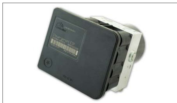
ATE MK60 - Défaut : « capteur de pression de freinage défectueux »
