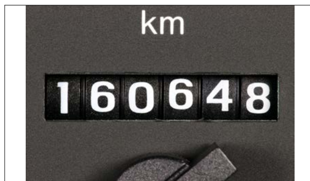
Le totalisateur de kilomètres ne fonctionne plus
