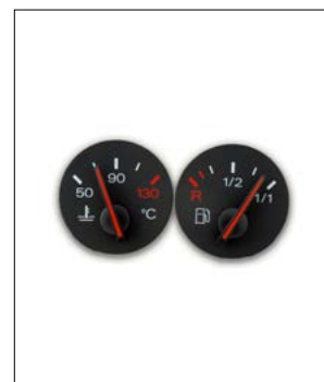
Affichage analogique défaillant (température du moteur et niveau de carburant)
