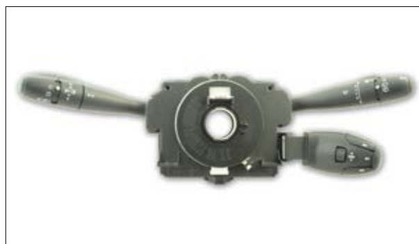
Dysfonctionnements divers (par ex. le clignotant ne fonctionne plus)
