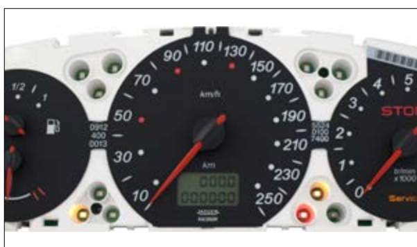
Affichage analogique défaillant (tachymètre et compte-tours)
