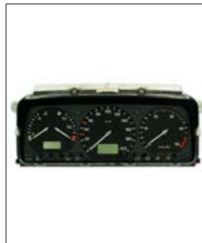
Affichage analogique défaillant (température du moteur et niveau de carburant)
