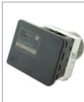
Défaut : « capteur de pression de freinage défectueux »
