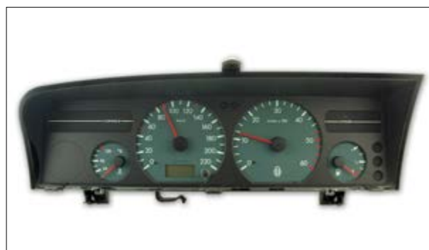
Affichage analogique défaillant (tachymètre et compte-tours)
