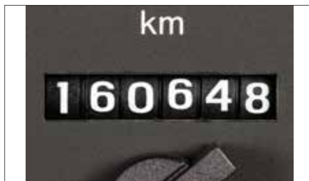
Le totalisateur de kilomètres ne fonctionne plus
