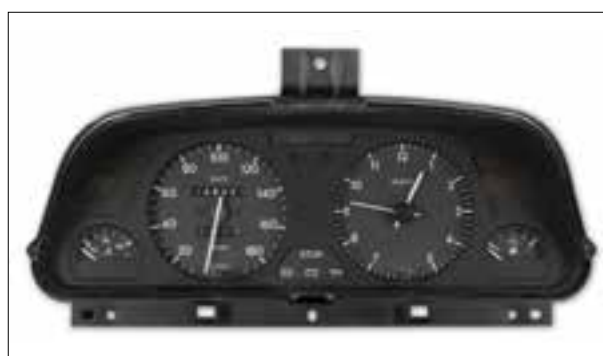
Affichage analogique défaillant
