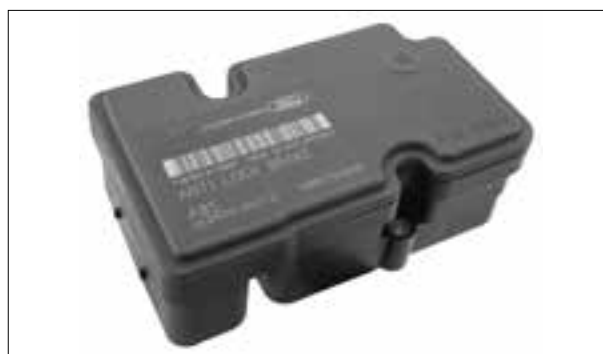
ATE MK70 - Défaut : « pas de communication »
