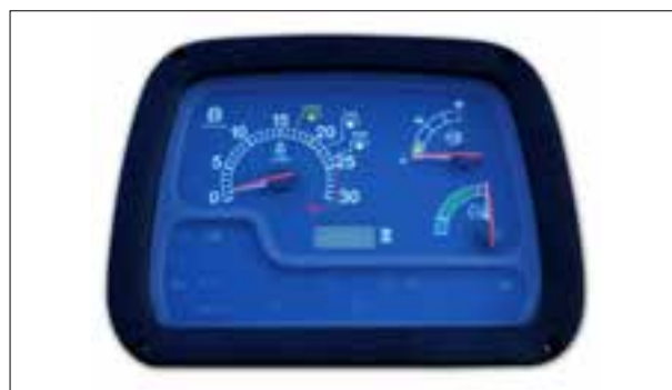
Compte-tours hors fonction et temps d'utilisation qui ne s'incrémente plus
