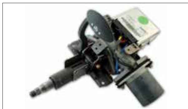
Panne aléatoire ou permanente de la direction assistée électrique
