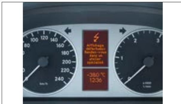
**Défaut de pixels ou de segments****Classe C Berline/Break (W202) | de 06/1997 à 02/2001****Mercedes-Benz****Calculateur ETS (Système de Traction Electronique)**
