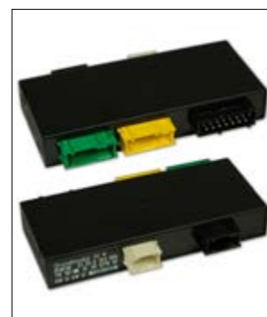
Verrouillage centralisé ou lève-vitres électriques en panne
