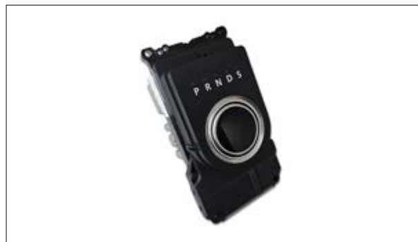
Code d'erreur P176C-11 : erreur de commande de verrouillage du sélecteur de transmission
