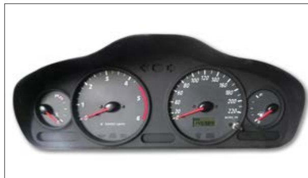
Panne totale aléatoire, mais souvent l'indicateur du niveau de carburant fonctionne encore
