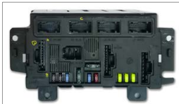
Boîte à fusibles
