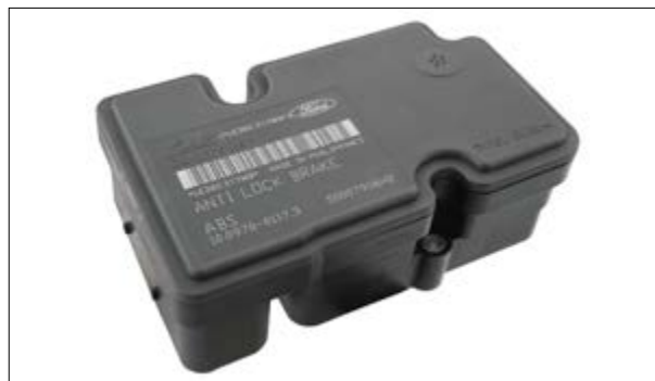
ATE MK70 - Défaut : « pas de communication »
