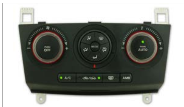
Boutons de réglage en panne - Plus de possibilité de régler la température
