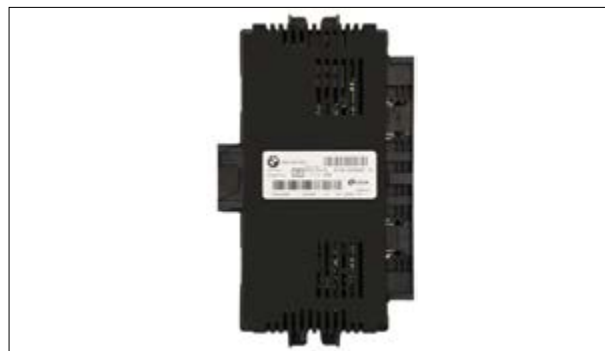
Module de plancher FRM3 : Dysfonctionnements divers
