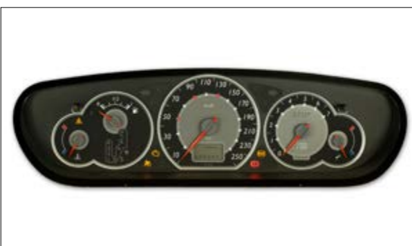
Affichage analogique défaillant (tachymètre et compte-tours)
