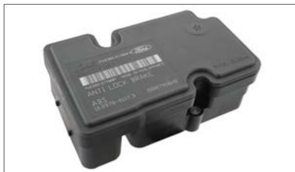
ATE MK70 - Défaut : « pas de communication »
