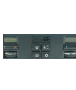
Panneau de commande climatisation
