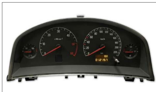
Affichage analogique défaillant
