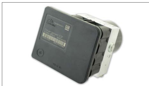
ATE MK60 - Défaut : « capteur de pression défectueux »
