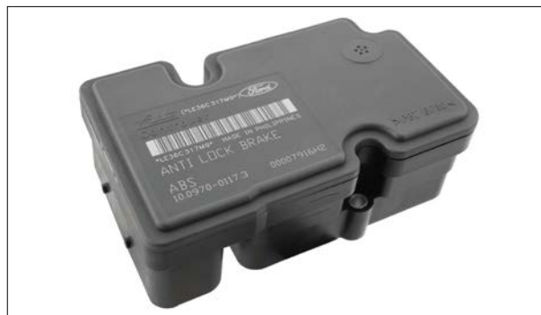
ATE MK70 - Défaut : « pas de communication »
