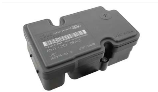
ATE MK70 - Défaut : « pas de communication »
