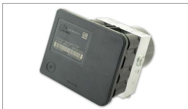
ATE MK60 - Défaut : « capteur de pression défectueux »
